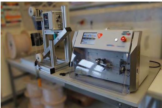
Zuerst müssen die Litzen geschnitten werden. Dafür gibt es diese Maschine .
