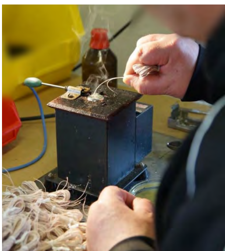
Hier werden jeweils an beiden Enden der Litzen gezinnt.
